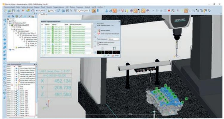
Module avancé pour le calcul des trajectoires MMT, sans collision et optimisées. Activation automatique des orientations têtes de mesure.
