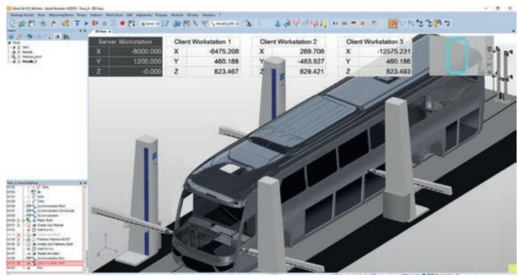
Simulation d'une configuration MMT quadriplex avec changeur d'outils.
