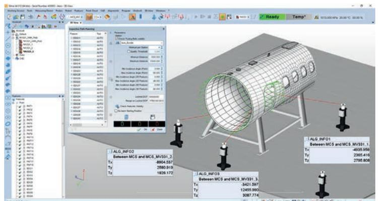
Module avancé pour le positionnement automatique du moyen de mesure.
